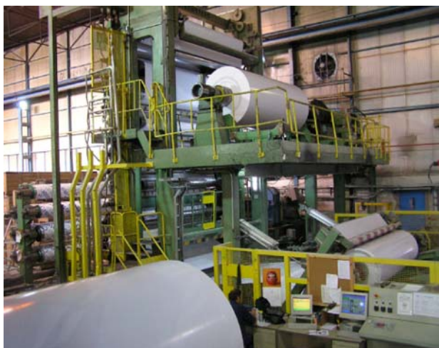
Vista general de la calandra.
